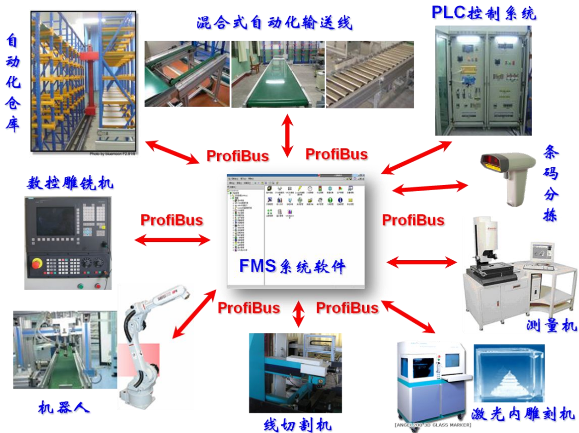
图 1 现代工厂自动化加工实验平台组成结构
