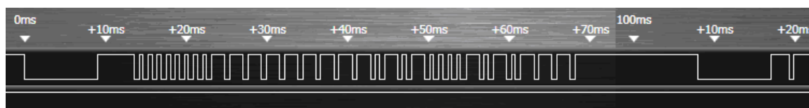
图 3.21.1.1 按键 2 所对应的红外波形
