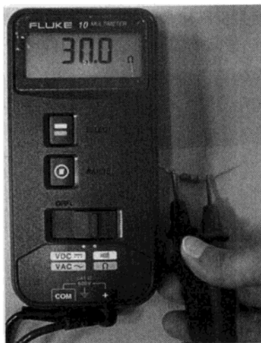
图 3-6 以上是电表，我们用测棒量出这个电阻的阻值为 30.0\Omega （误差值的正负 0.1）
