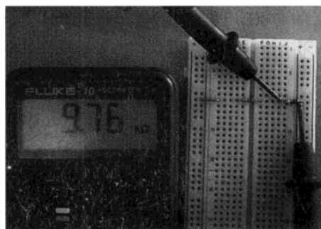
图 1-25 用电表实际量测 10\text{k}\Omega 的电阻，测量 结果为 9.76\text{k}\Omega
