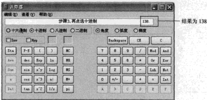
图 3-62 使用“科学型”计算器,单击十六进制并且键入 8A 后,将鼠标移到十进制同时单击十进制
