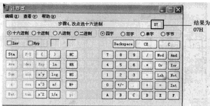
图 3-60 在得到 215 二进制的表示方式后，再用鼠标单击选十六进制，我们很快看到数值 215 十六进制的表示方式为 D7H
