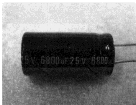
图 3-27 铝质电解电容，通常电容量都会标示在上面
