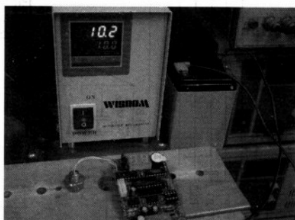
图 9-41 恒温槽的温度设置是 10°C, 用 AT2051 控制板量到的温度是 9°C
