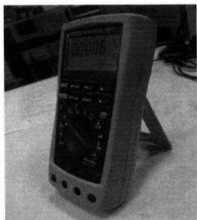
图 20-3 数字电表外部全部用高绝缘性且耐摔的材质包围
