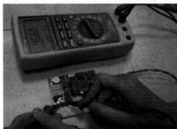
图 20-14 测量 CPU 的电源电压
