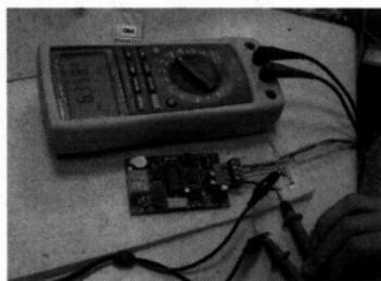
图 20-15 测量 AT2051 控制板的消耗电流，静态测量约为 6mA 上下
