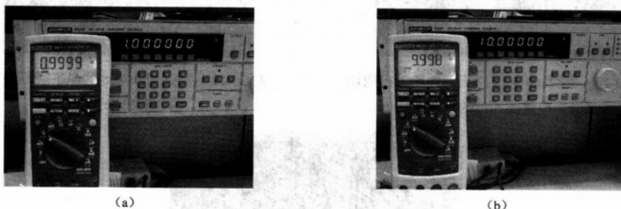
图 20-20 直流电压校正方法，检查 1.000V 与 10.000V 的准确度
