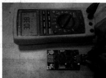
图 20-17 检查 SIO 对地的电平（不进行数据传输时）
