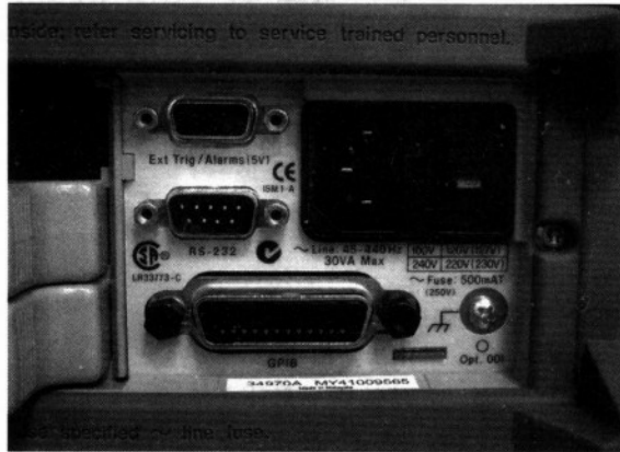
图 13-11 HP34970 数据收集器背后有串行通信端口
